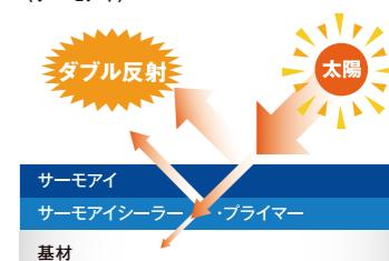
上塗りには「赤外線透過テクノロジー」を採用。上塗りの遮熱性能を向上させただけでなく、上塗り層で反射できない赤外線をなるべく吸収させずに透過させることで、下塗り遮熱性能との相乗効果を発揮します。「ダブル反射」<sup>※4</sup>は上塗りと下塗りの遮熱効果を最大限に引き出した遮熱システムです。
