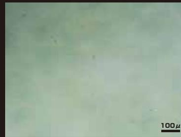
【試験条件】試験板に大腸菌液を滴下後、温度 37℃ 環境下で 24 時間静置。メチレンブルーを用いて菌を染色し、光学顕微鏡を用いて表面を観察。
