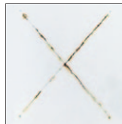
当社弱溶剤1液変性エポキシ樹脂系さび止め塗料 当社弱溶剤一般シリコン樹脂系上塗り塗料 (下塗り1回、上塗り2回の計3回塗り)
