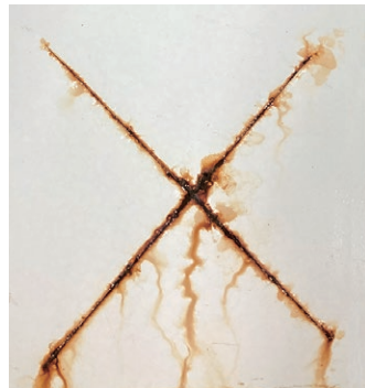
当社弱溶剤変性エポキシ樹脂下塗り塗料 (60μm×2回)
